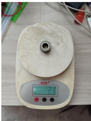
Рисунок 4.1 – Подшипник весом примерно 20 грамм.
